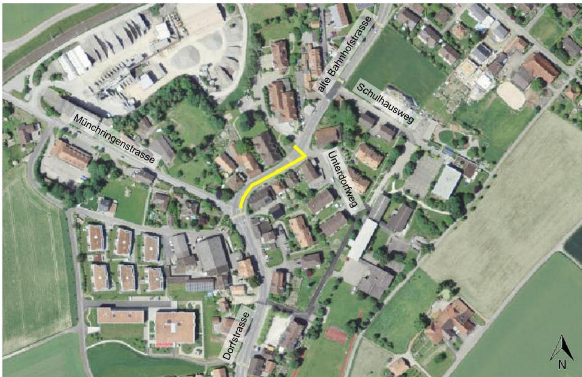
Zwischen Schulhausweg, dem Kreisel Münchringenstrasse bis vor das Geschäft Bike Sport Bütikofer, verläuft eine bestehende Kanalisationsleitung, welche hydraulisch ungenügend ist. Der Durchmesser der Kanalisation wird von 350 mm auf 600 mm vergrößert werden.
